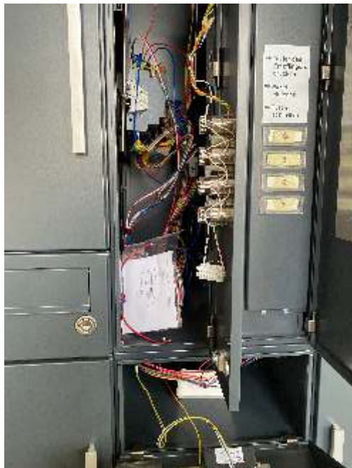
Geöffnetes Sprechanlagenfach mit Steuerung für Fach 1-4 Das Scannerfach lässt sich nach unten klappen in dem die darüber liegenden Türen um 90° geöffnet werden.
